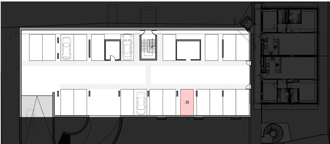
PLANTA ESTACIONAMENTO - PISO 02 | SEM ESCALA
